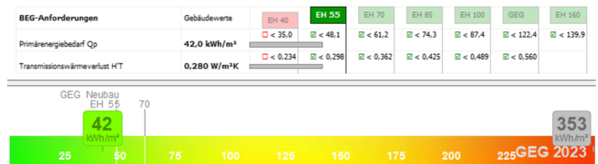
Abbildung 87: Darstellung des Primärenergiebedarfs des Typ C-Gebäudes in der Sanierungsvariante 2
