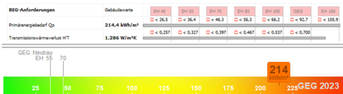
Abbildung 88: Darstellung des Primärenergiebedarfs des Typ D-Gebäudes in der Ausgangslage
