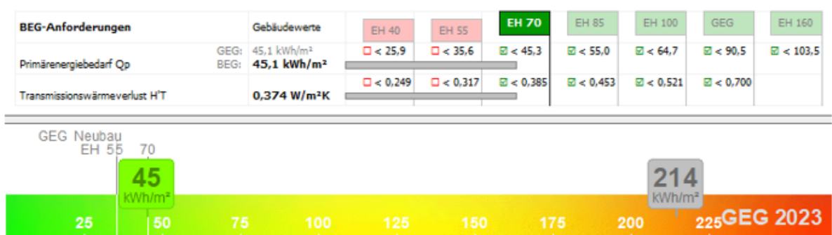
Abbildung 89: Darstellung des Primärenergiebedarfs des Typ D-Gebäudes in der Sanierungsvariante 1
