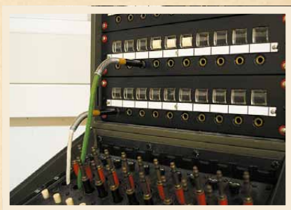
Handvermittlung aus dem Besitz der Stadtverwaltung: Mit Klinkensteckern wurde händisch die Verbindung zwischen zwei Teilnehmern hergestellt
