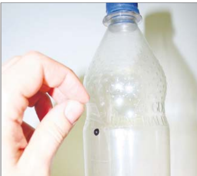
Abb. 2: Löcher einstechen, markieren und abkleben.
